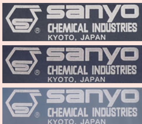
図5 耐水試験後の皮膜白化の様子
