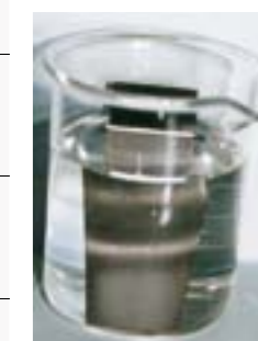
さび止め剤あり
